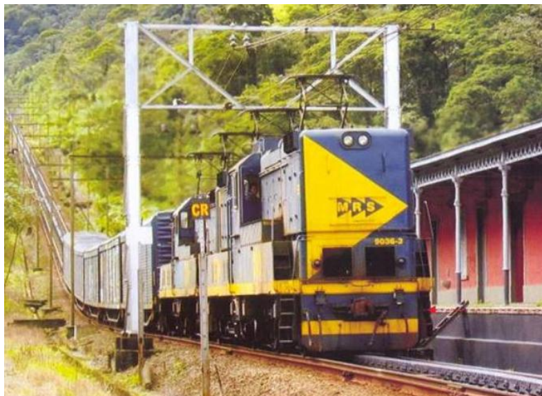
Figura 4: Sistema de cremalheira-aderência na Serra do Mar entre Paranapiacaba e Cubatão
